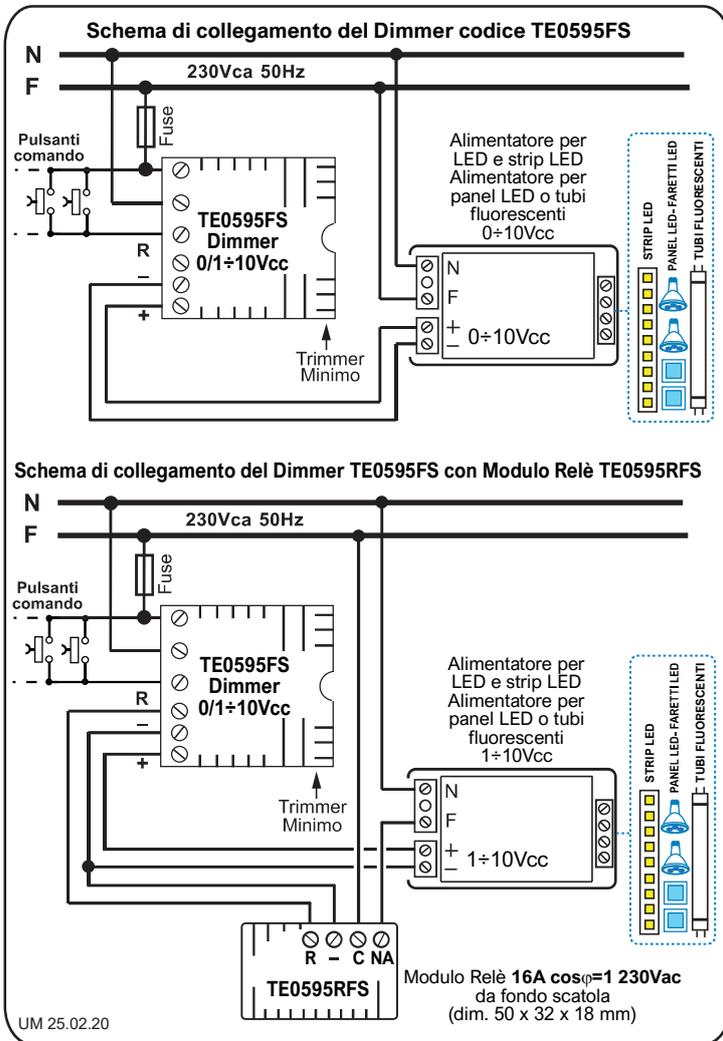
**DIMMER 0/1±10Vcc Attivo cod. TE0595FS da fondo scatola CON COMANDO A PULSANTI PER ALIMENTATORI, DRIVERS E BALLAST DIMMERABILI 0/1±10VCC LED E FLUORESCENZA**
