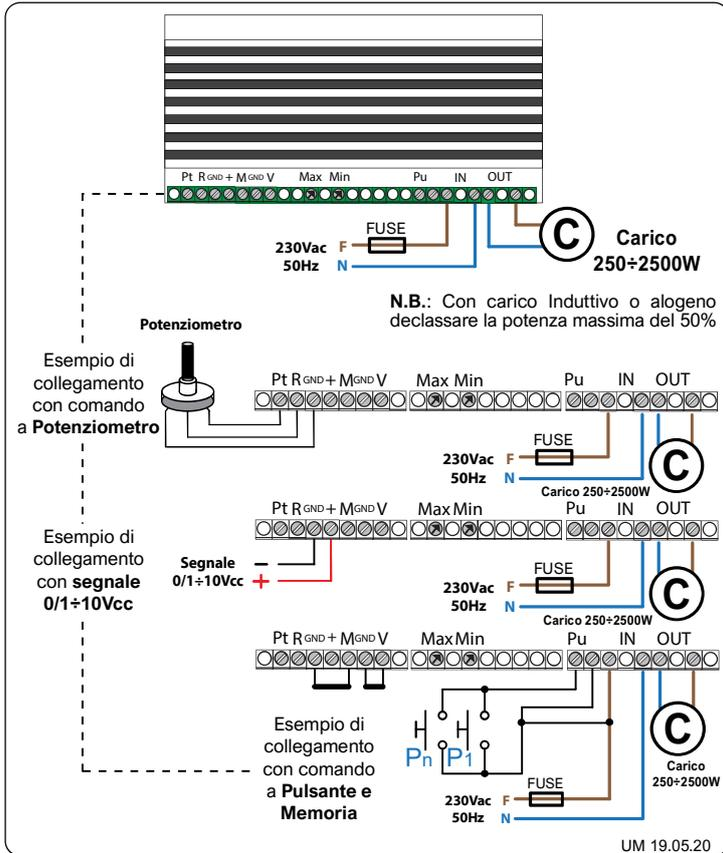
Regolatore elettronico monofase a Triac in Leading edge cod. TE7774.25 multicomando a 9 moduli da Guida DIN per Carico Resistivo e Induttivo, 230Vca 50Hz con filtro antidisturbo incorporato. Conforme alle normative EMC 89/336/CEE, 92/31/CEE e Direttive B.T.72/23/CEE,93/68/CEE.
