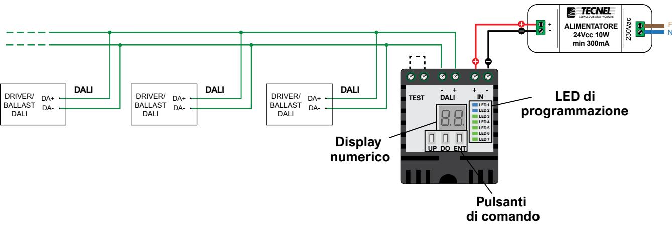
Il PRODALI è un **mini programmatore per sistema DALI** che permette di programmare, senza la necessità di strumentazione specifica e senza l'utilizzo di un PC esterno, dei dispositivi di tipo DALI. Inoltre può essere utilizzato come **mini alimentatore per sistemi DALI inseribile nel fondo di scatole portafrutto da incasso**.
