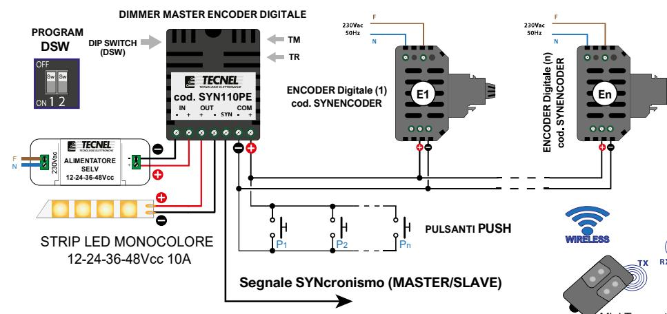
Il Dimmer STRIP LED codice SYN110PE programmato nelle funzione di **MASTER con comando ENCODER DIGITALE + PUSH B.T. (Bassa Tensione)** può essere comandato da più punti anche da locali diversi con infiniti **ENCODER DIGITALI** codice **SYNENCODER E1... + En** installati in abbinamento misto a infiniti **Pulsanti remoti con contatto NA P1 + P2 ... + Pn** purché la lunghezza dei due fili di collegamento che opera in Bassa Tensione **non superi i 100 metri**.
