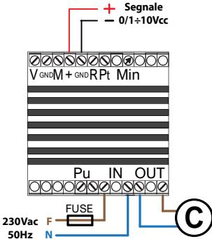
Esempio di collegamento con comando a Potenziometro
