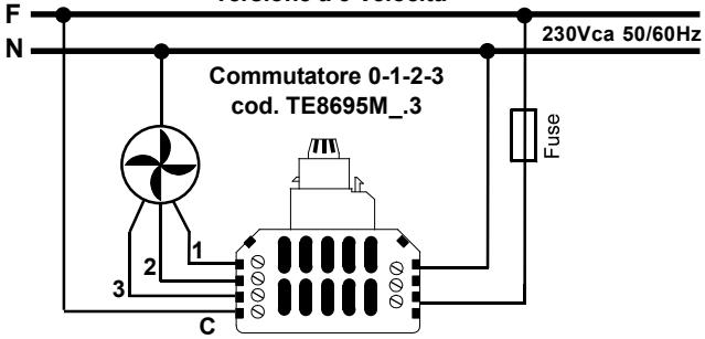
Potenza contatti Relè in scambio interni al dispositivo 5A cos $\phi$ =1 230Vca
